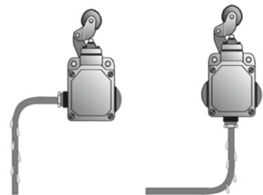
Abb. 46 Beispiele für bevorzugte Leitungszuführungen
