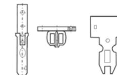
Abb. 9 Beispiele für Betätiger an Positionsschaltern Bauart 2.
