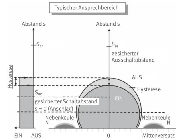
Abb. 17 Beispiel für einen typischen Ansprechbereich eines Näherungsschalters
