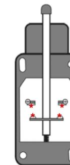
Selbst bei „verschweißten“ Kontakten wird der Öffnerkontakt durch Betätigen des Schalters zwangsläufig geöffnet (auch wenn er dadurch zerstört wird).
