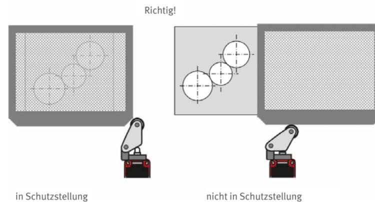
Abb. 32 Funktionsrichtige Anordnung eines Positionsschalters Bauart 1
