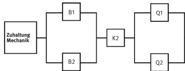
Abb. 58 Blockdiagramm der Sicherheitsfunktion Zuhaltung
