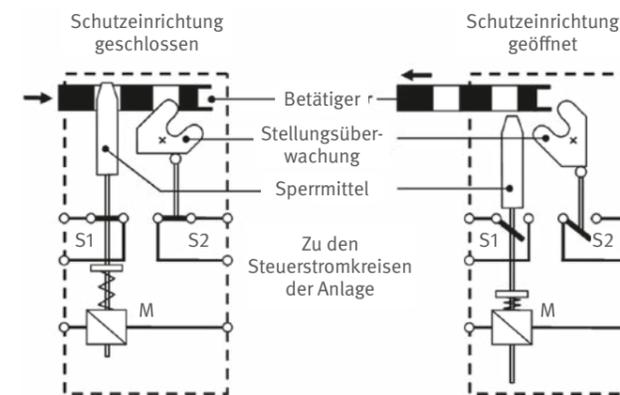
Abb. 22 Mechanische Zuhaltung nach dem Ruhestromprinzip
