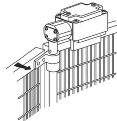
Abb. 35 Bsp. Scharnierschalter
