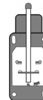
Selbst bei gebrochener Feder wird der Öffnerkontakt durch Betätigen des Schalters zwangsläufig geöffnet
