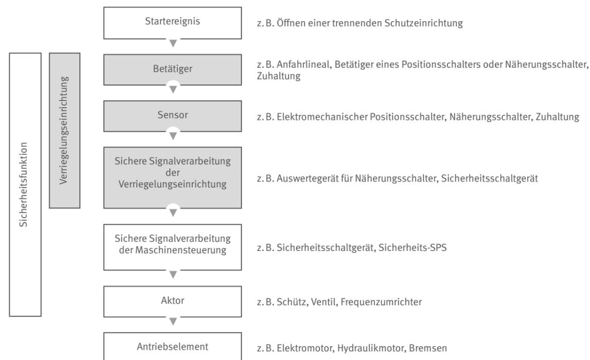
Abb. 1 Beispiel einer Verriegelungseinrichtung als Teil einer Signalverarbeitungskette
