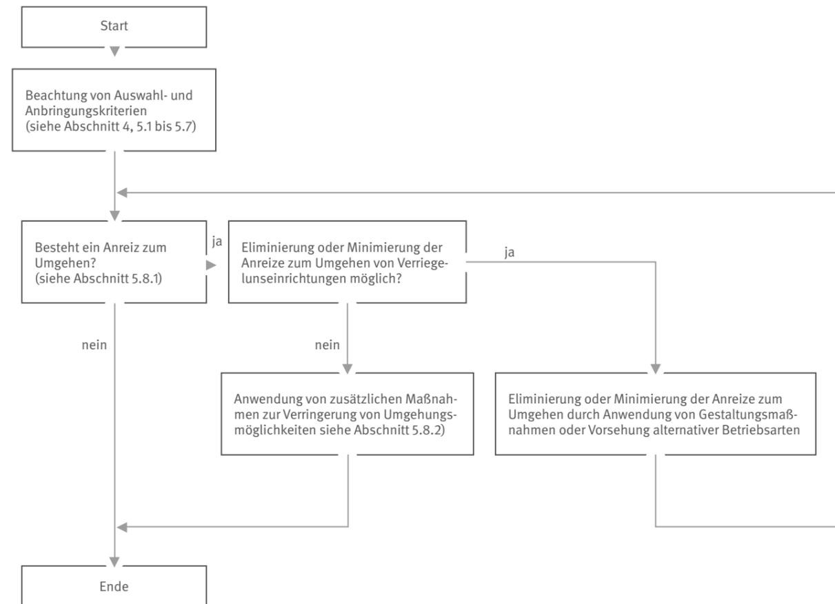
Abb. 49 Methodik zur Bestimmung und Beseitigung von Umgehungsmöglichkeiten [8]
