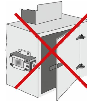
Abb. 33 Unzulässige Anbringung eines Positionsschalters Bauart 1
