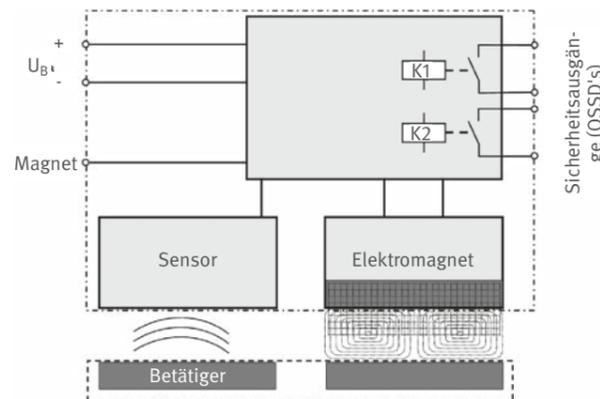
Abb. 24 Elektromagnetische Zuhaltung nach dem Arbeitsstromprinzip
