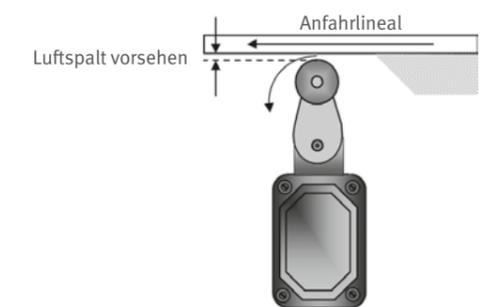
Abb. 44 Richtige Formgebung des Steuerlineals bei Rollenschwenkhebelschaltern
