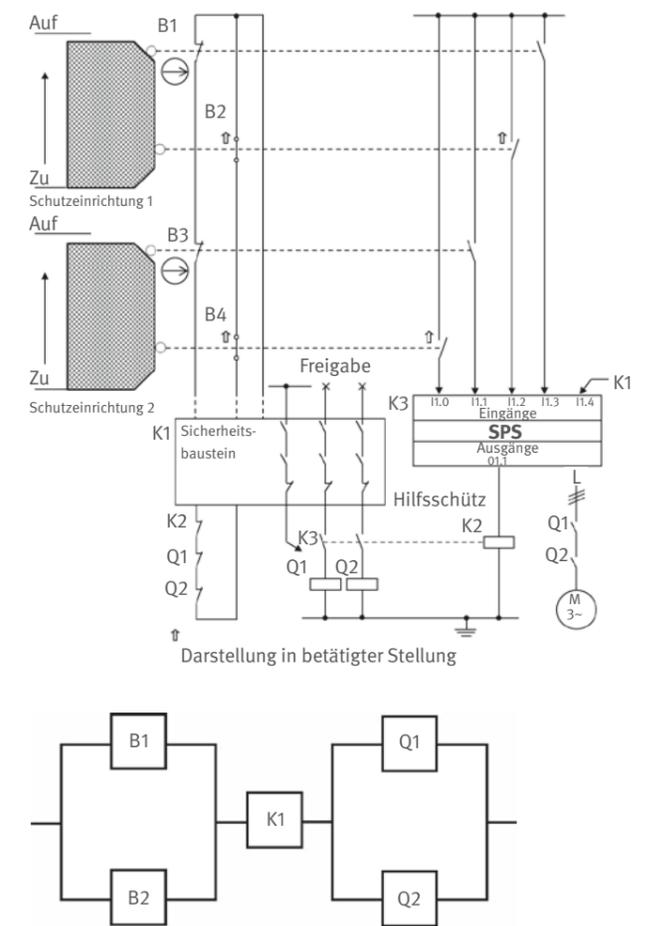
Abb. 53 Stellungsüberwachung beweglicher trennender Schutzeinrichtungen mit Blockschaltbild
