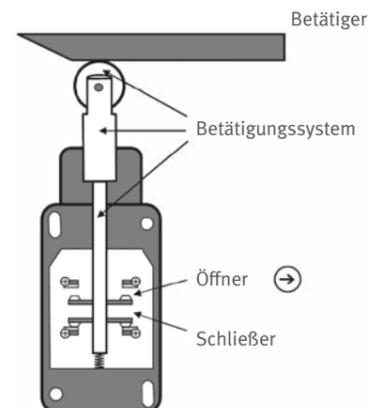
Abb. 5 Aufbau Positionsschalter Bauart 1 (Schutzeinrichtung nicht geschlossen)
