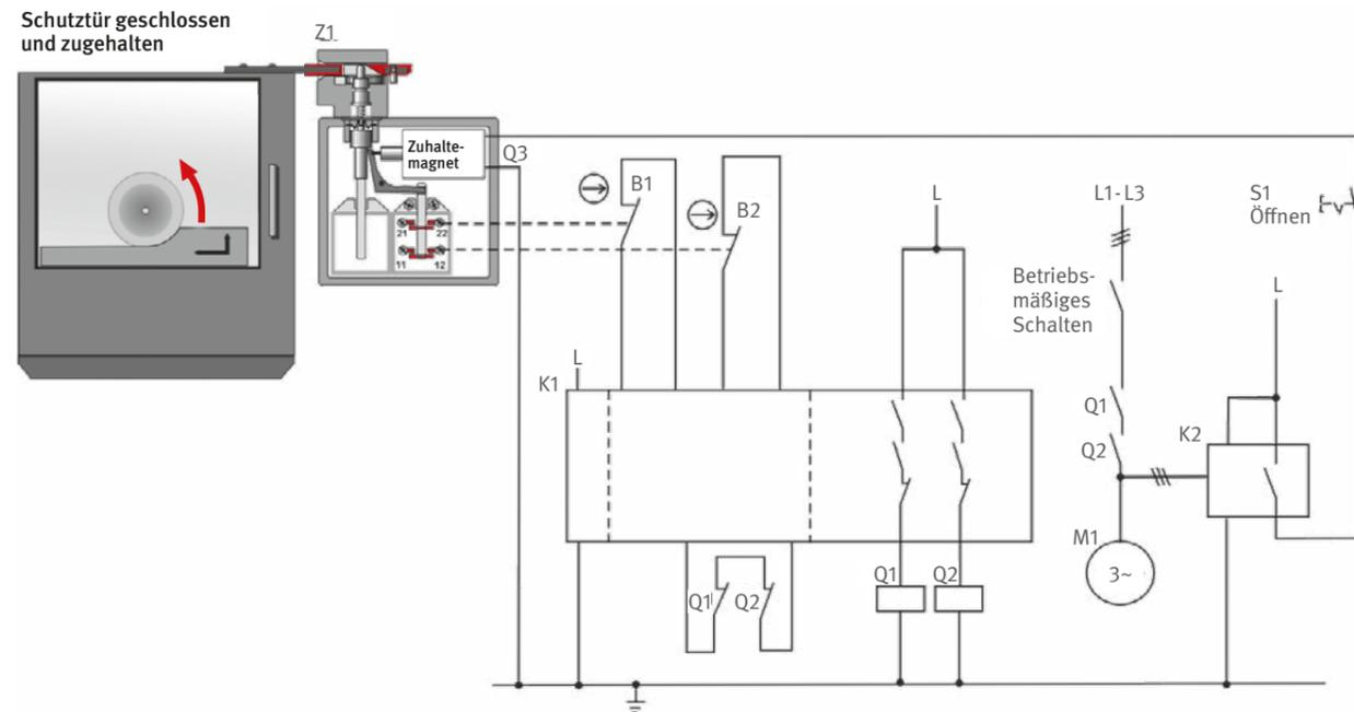
Abb. 54 Stellungüberwachung beweglicher trennender Schutzeinrichtungen
