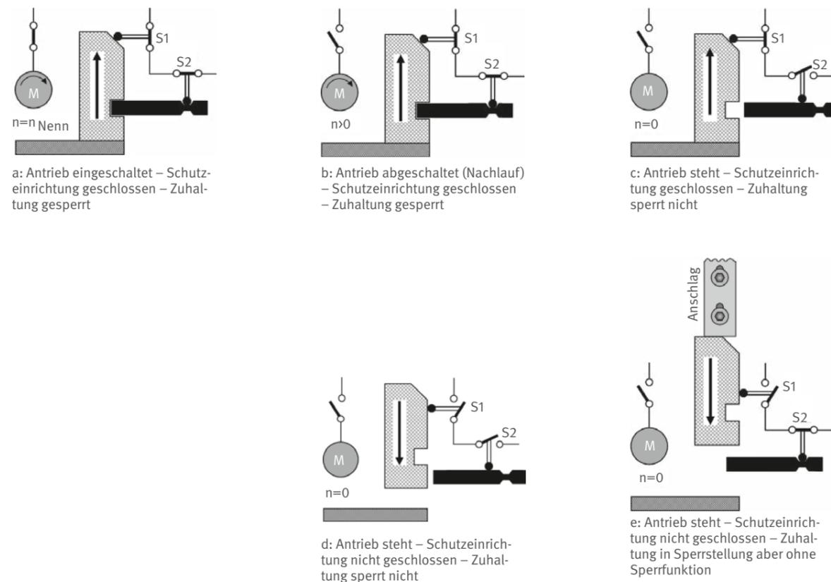
Abb. 19 Funktionsprinzip einer Zuhaltung
