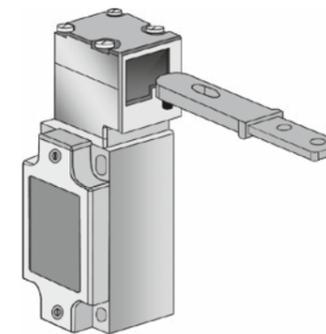
Abb. 7 Beispiel für einen Positionsschalter Bauart 2
