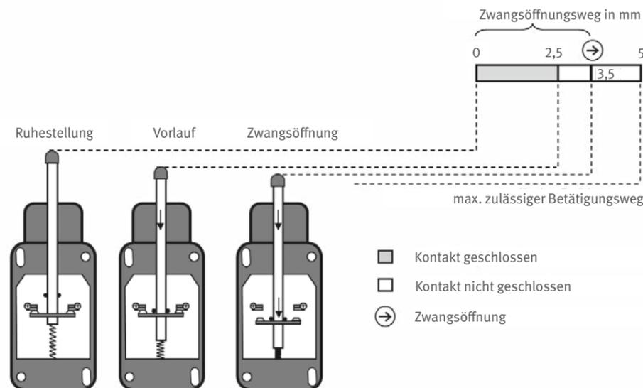
Abb. 12 Beispiel für einen Positionsschalter Bauart 2
