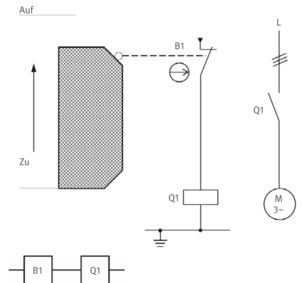
Abb. 51 Stellungenüberwachung einer beweglichen trennenden Schutzeinrichtung mit Blockschaltbild
