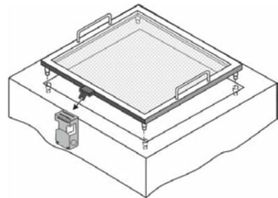
Abb. 37 Positionsschalters Bauart 2 an einer abnehmbaren Schutzvorrichtung
