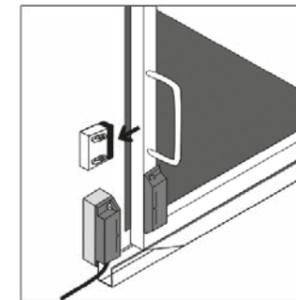
Abb. 41 Montage mit zusätzlichem mechanischen Anschlag
