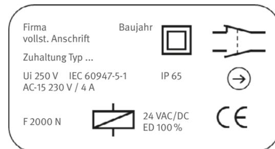
Abb. 28 Beispiel eines Typschildes für eine Zuhaltung
