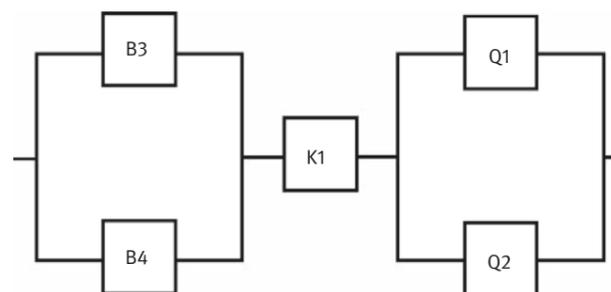
Abb. 59 Blockdiagramm der Sicherheitsfunktion Verriegelung
