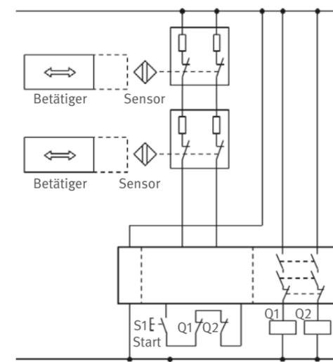
Abb. 27 Kaskadierung von Näherungsschaltern
