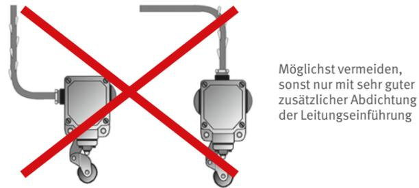
Abb. 45 Beispiele für nicht empfohlene Leitungseinführungen
