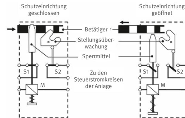
Abb. 23 Mechanische Zuhaltung nach dem Arbeitsstromprinzip
