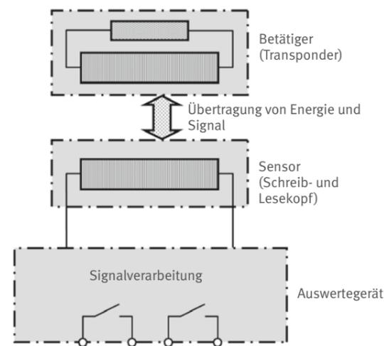
Abb. 16 Näherungsschalter kodiert, Transponderprinzip
