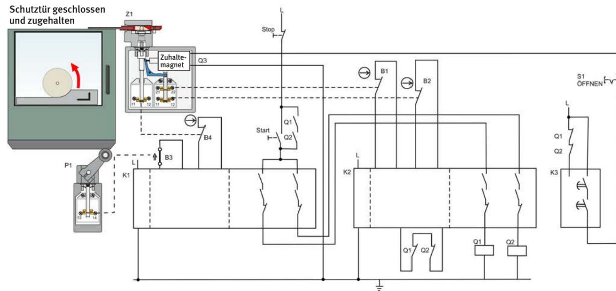
Abb. 57 Stellungüberwachung einer beweglichen trennenden Schutzeinrichtung mit Zuhaltung
