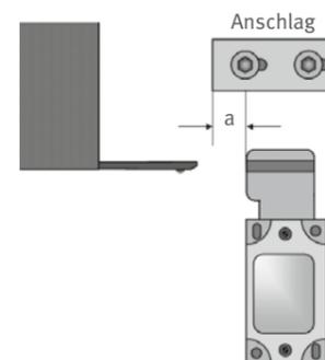
Abb. 40 Montageart mit einem zusätzlichen mechanisch verstellbaren Anschlag
