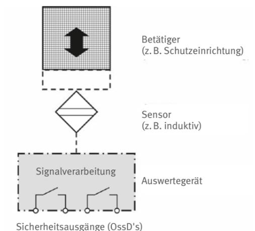
Abb. 14 unkodierter Näherungsschalter
