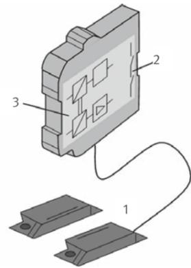
Abb. 26 Näherungsschalter mit Sensor (1), Sicherheitsausgängen (2) und Auswertegerät (3)
