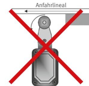
Abb. 43 Falsche Formgebung des Steuerlineals bei Rollenschwenkhebelschaltern
