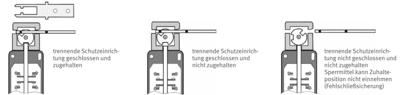
Abb. 20 Zuhaltung mit Fehlschließung
