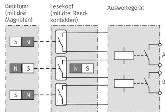
Abb. 15 Näherungsschalter kodiert mit Reedkontakten
