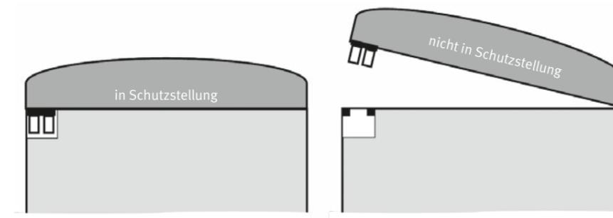
Abb. 36 Stellungsüberwachung einer Schutzeinrichtung an der Schließkante
