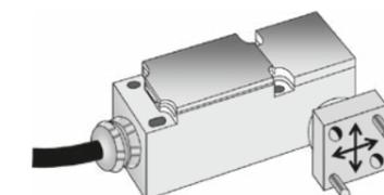
Abb. 30 Beispiel für mögliches Sichern eines Betätigers gegen Lageänderung
