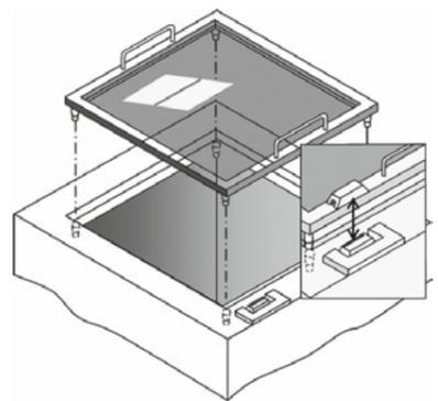
Abb. 38 Näherungsschalter an einer abnehmbaren Schutzvorrichtung
