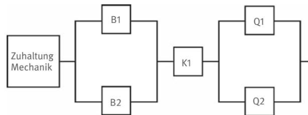
Abb. 56 Blockdiagramm der Sicherheitsfunktion Verriegelungseinrichtung und Zuhaltung
