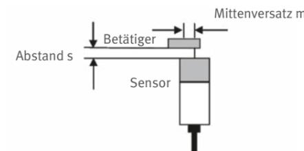
Abb. 17a Mitterversatz bei einem Näherungsschalter
