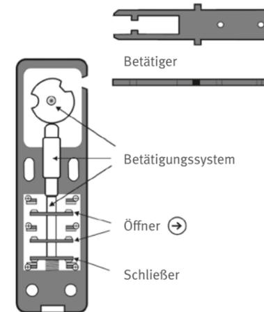
Abb. 8 Aufbau Positionsschalter Bauart 2 (Schutzeinrichtung nicht geschlossen)
