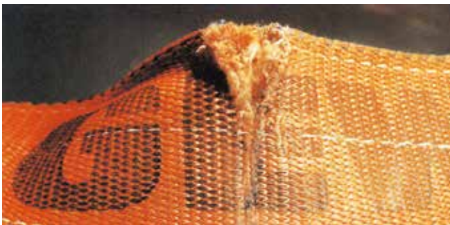
Bild 23-14: Durch scharfkantige Last eingeschnittenes Hebeband
