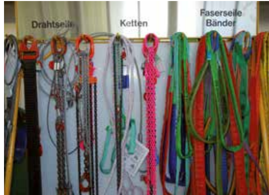
Bild 24-1: Vorbildliche Aufbewahrung von Seilen und Ketten
