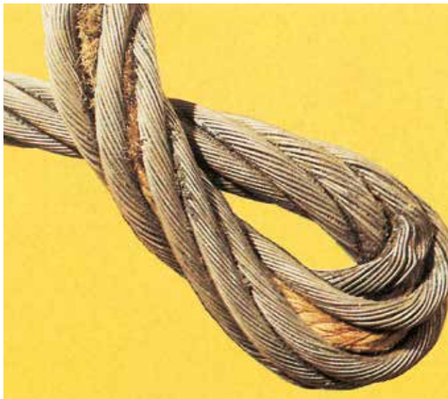
Bild 23-4: Kinke/Klanke und Eindrückung einer Litze. Der Seilverbund ist zerstört: Ablegen!
