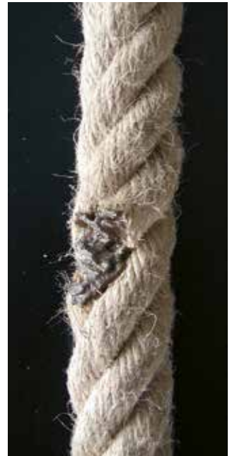
Bild 23-9: Wärmeeinfluss hat eine Litze zerstört
