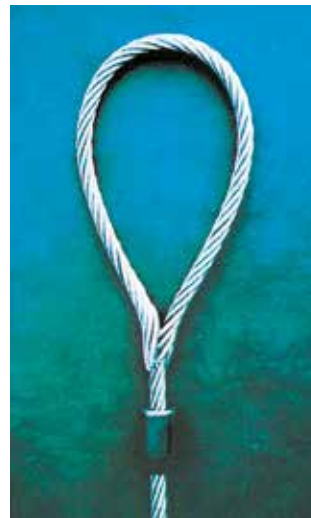
Bild 9-7: Die beiden Enden sind gegeneinander verseilt
