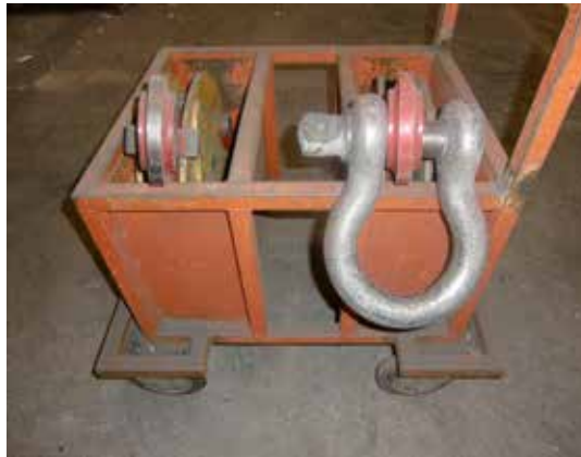
Bild 24-2: Abgestellte, gegen Umfallen gesicherte Lastaufnahmemittel
