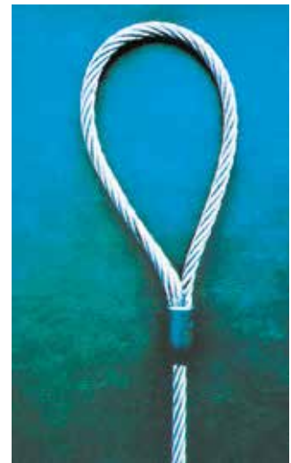
Bild 9-8: Über die gegenläufig verseilten Enden ist eine angeschrägte Stahlpresshülse geschoben und verpresst
