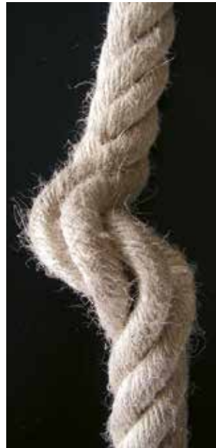
Bild 23-8: Durch Klanke zerstörter Litzenverbund
