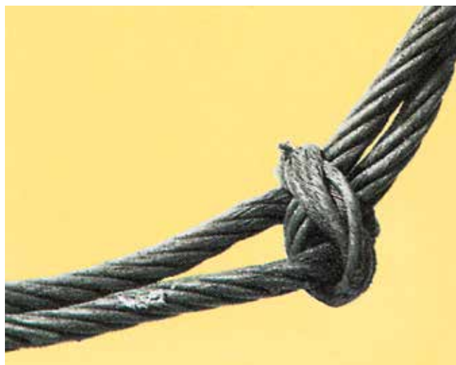
Bild 9-2: Unzulässiger Knoten zerstört den Seilverbund
