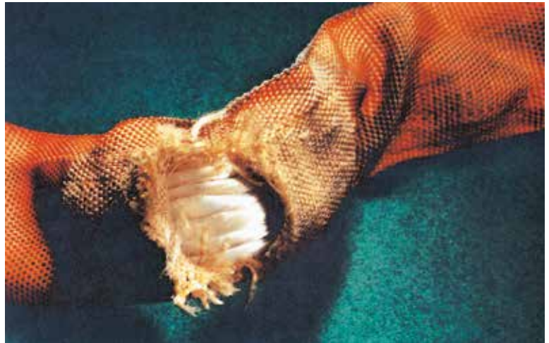
Bild 23-16: Durch Wärmeeinfluss zerstörte Ummantelung; Ablegereife auch wegen Sichtbarkeit der Einlage erreicht
