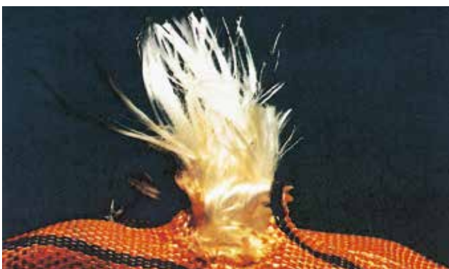
Bild 23-15: Durch Schnitte beschädigte Ummantelung und Einlage einer Rundschlinge
