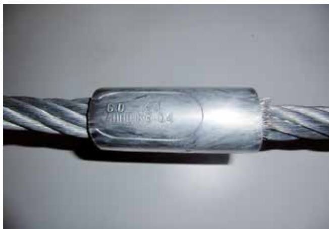
Bild 9-1: Pressklemme mit Verpresserkennzeichen
