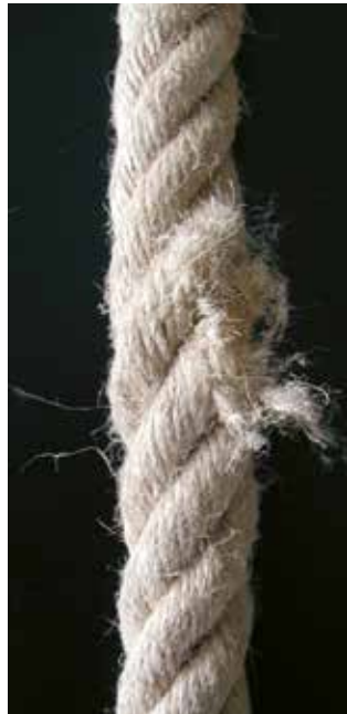
Bild 23-7: Zerstörung einer Litze
