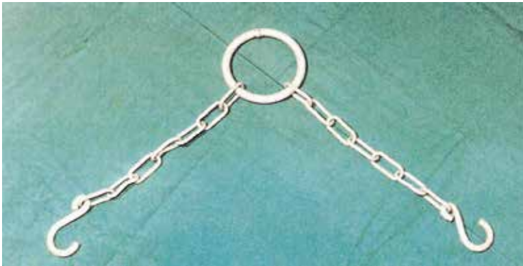
Bild 11-1: Eine langgliedrige Kette darf selbst im Neuzustand nicht als Anschlagmittel verwendet werden. Die Kettenglieder verbiegen!
