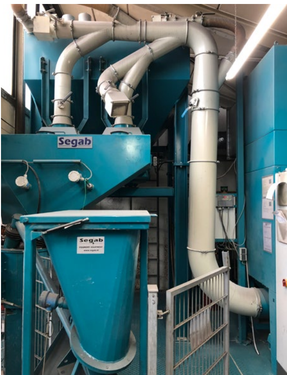
Abb. 21 Feinsandsichtung an Kernschießanlage und Auffangbehälter für feinen Staub
