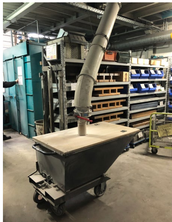
Abb. 21 Feinsandsichtung an Kernschießanlage und Auffangbehälter für feinen Staub
