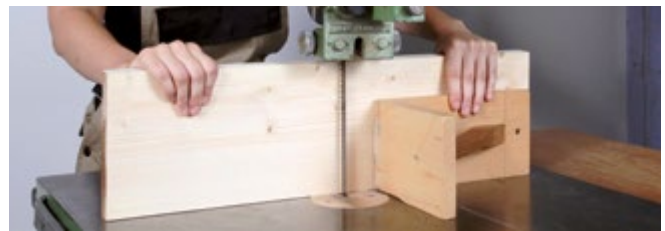
Abb. 3.1.6-08 Quersägen hochkant stehender Werkstücke
