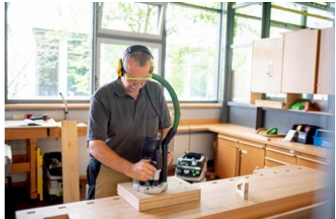
Abb. 3.3.2-02 Maschine an Absaugeinrichtung anschließen
