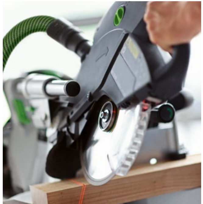
Abb. 3.1.4-04 Laser zur Anzeige der Schnittlinie
