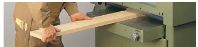
Abb. 3.1.10-05 Werkstück auf Dicke hobeln
