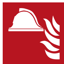
f004 Mittel und Geräte zur Brandbekämpfung
