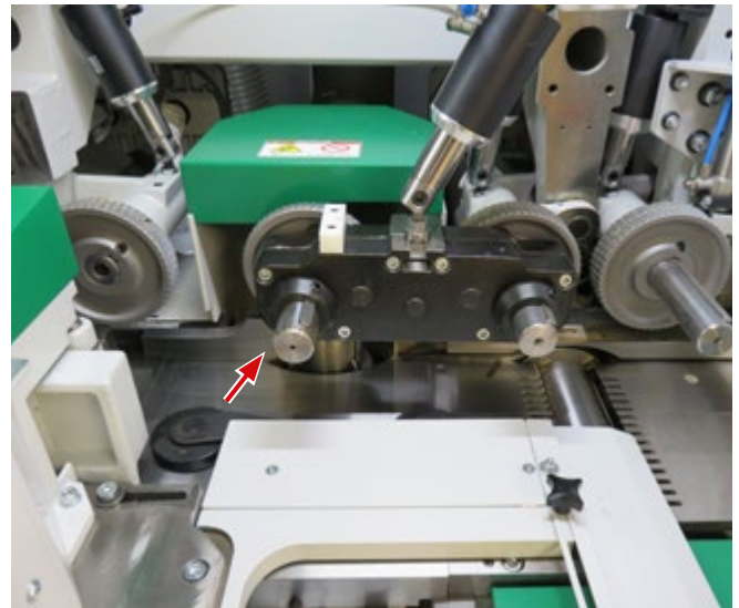
Abb. 3.1.13-05 Verdeckung einer hinteren Vertikalspindel mit Aufsteckspindel
