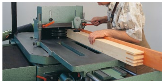
Abb. 3.1.8-05 Handvorschub = Arbeiten mit dem Schiebeschlitten
