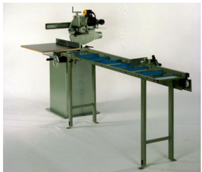
Abb. 3.1.5-05 Auslegerkreissägemaschine mit Werkstückauflage
