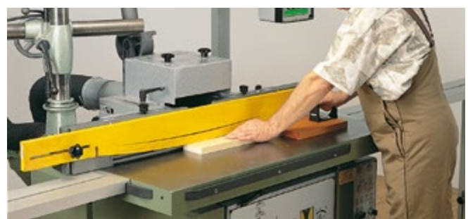
Abb. 3.1.8-07 Handvorschub = Halten und Führen der Werkstücke von Hand
