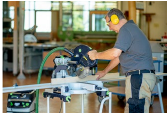
Abb. 3.1.4-02 Mobile Kapp-/Gehrungskreissägemaschine mit zusätzlicher Werkstückauflage
