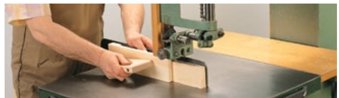
Abb. 3.1.6-10 Sägen kurzer Werkstücke mit Zuführhilfe
