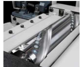
Abb. 3.1.9-08 Spiralhobelmesserwelle mit Einwegwendemessern
