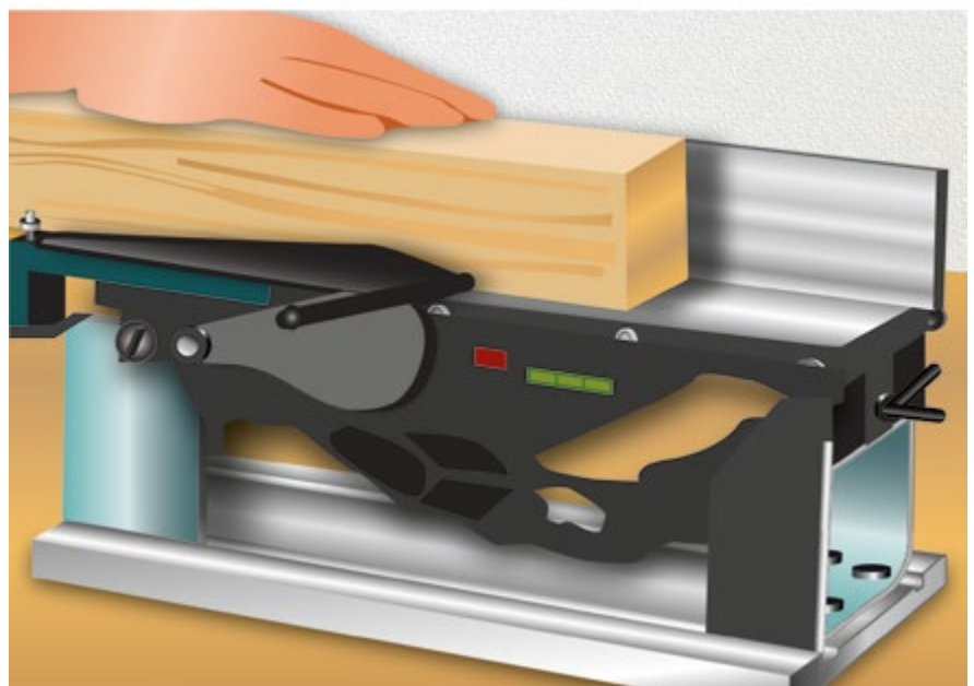
Abb. 3.3.3-02 Elektrohandhobel in stationärer Aufnahme
