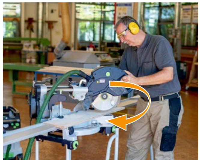
Abb. 3.1.4-05 Sägevorgang beim Einsatz der Zugfunktion
