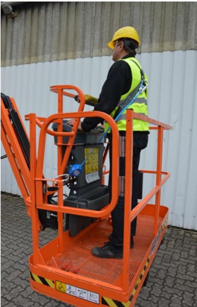
Abb. 3.5.4-02 Einsatz eines Höhensichtungsgeräts im Arbeitskorb
