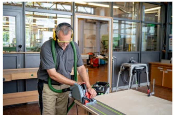
Abb. 3.3.1-11 Sägen mit Führungsschiene
