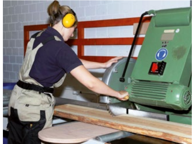
Abb. 3.1.5.06 Handhaltung beim Sägevorgang an einer Pendelkreissägemaschine
