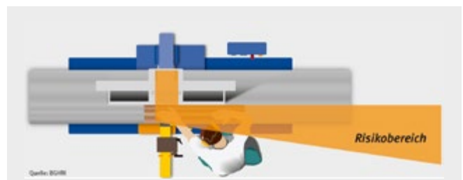
Abb. 3.1.9-02 Risikoaufenthaltsbereich an einer Abrichthobelmaschine
