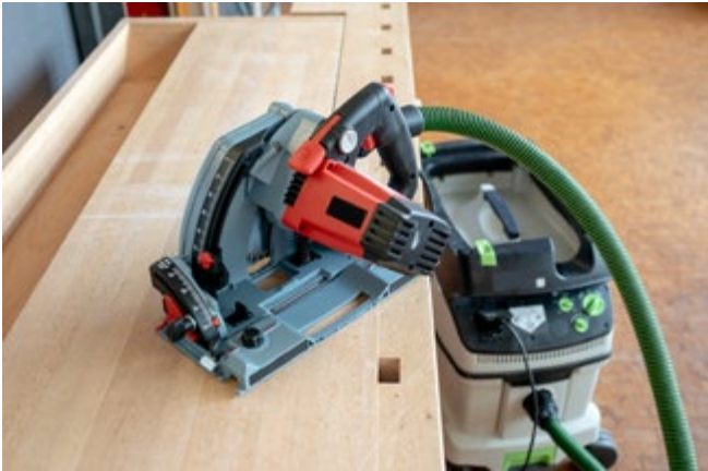
Abb. 3.3.1-09 Handkreissäge mit Absaugung
