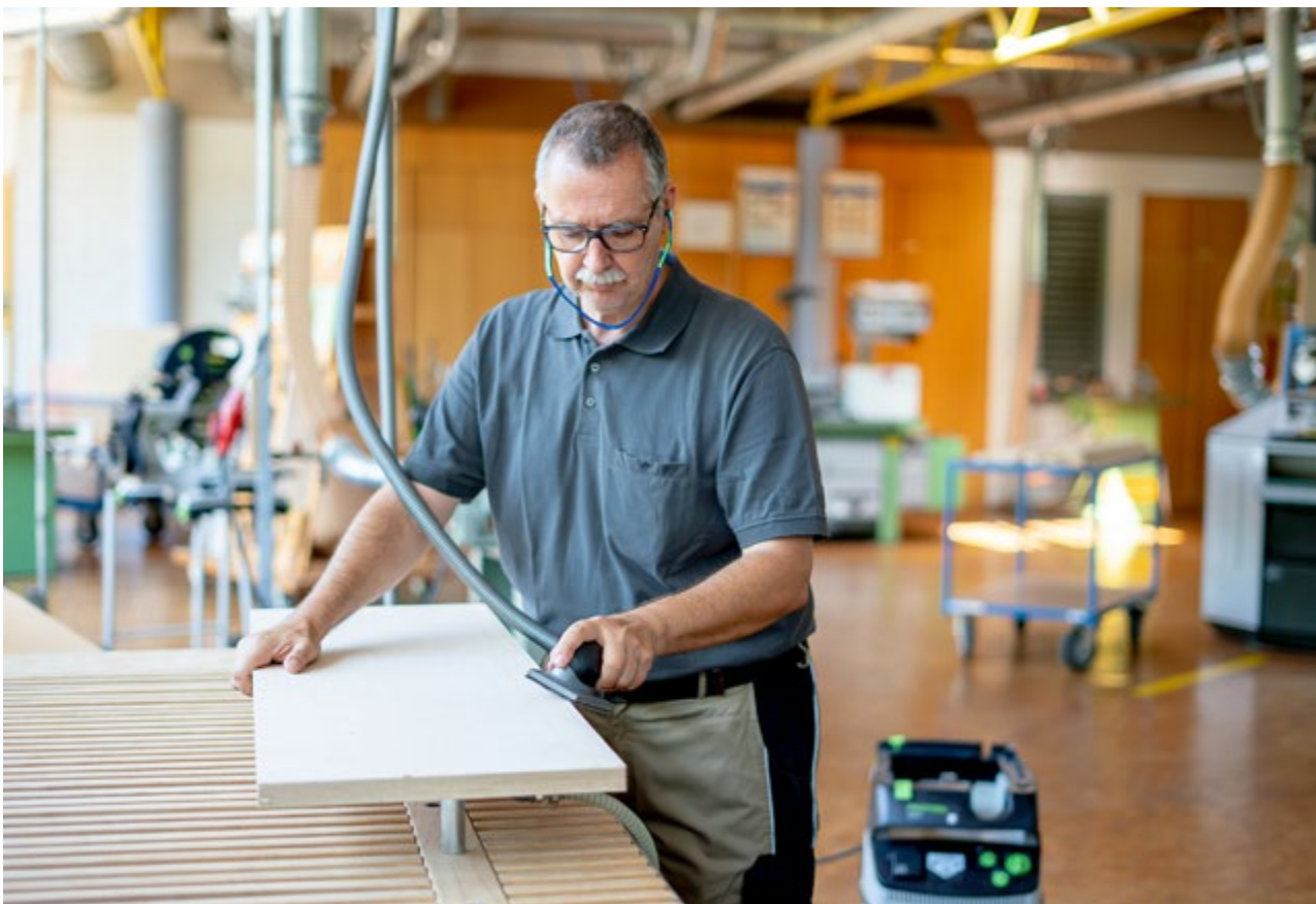
Abb. 3.3.6-01 Handschleifarbeiten mit abgesaugtem Handschleifklotz
