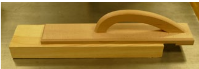
Abb. 3.1.9-05 Zuführlade und Schiebeholz für kurze Werkstücke
