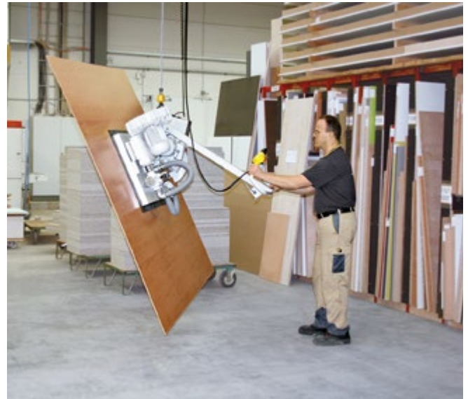
Abb. 3.1.2-08 Vakuum-Hebegerät für das Plattenhandling
