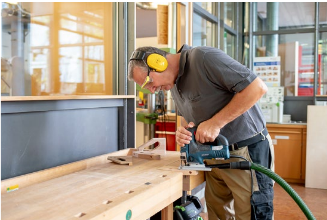
Abb. 3.3.4-02 Werkstücke sicher aufliegen und fixieren
