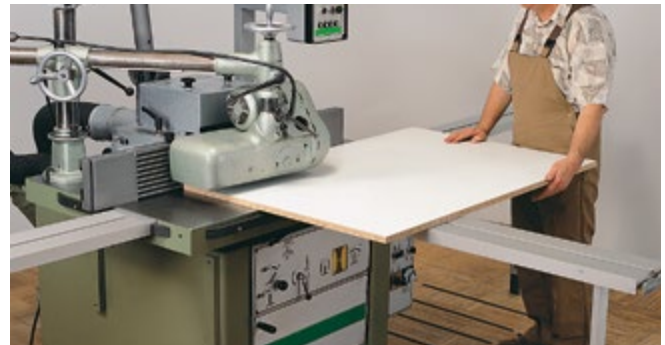
Abb. 3.1.8-04 Handvorschub = Arbeiten mit dem Vorschubapparat
