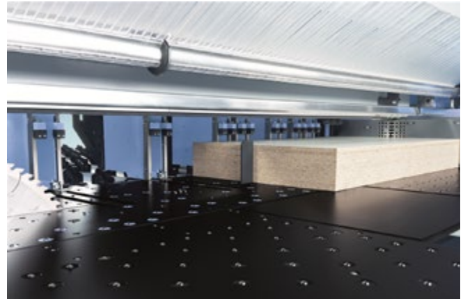
Abb. 3.1.3-02 Hohes Plattenpaket mit Winkelandrückvorrichtung
