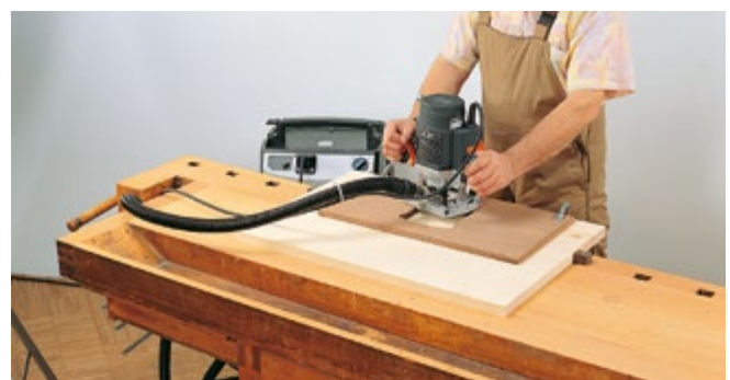
Abb. 3.1.8-06 Handvorschub = Arbeiten mit Handmaschinen
