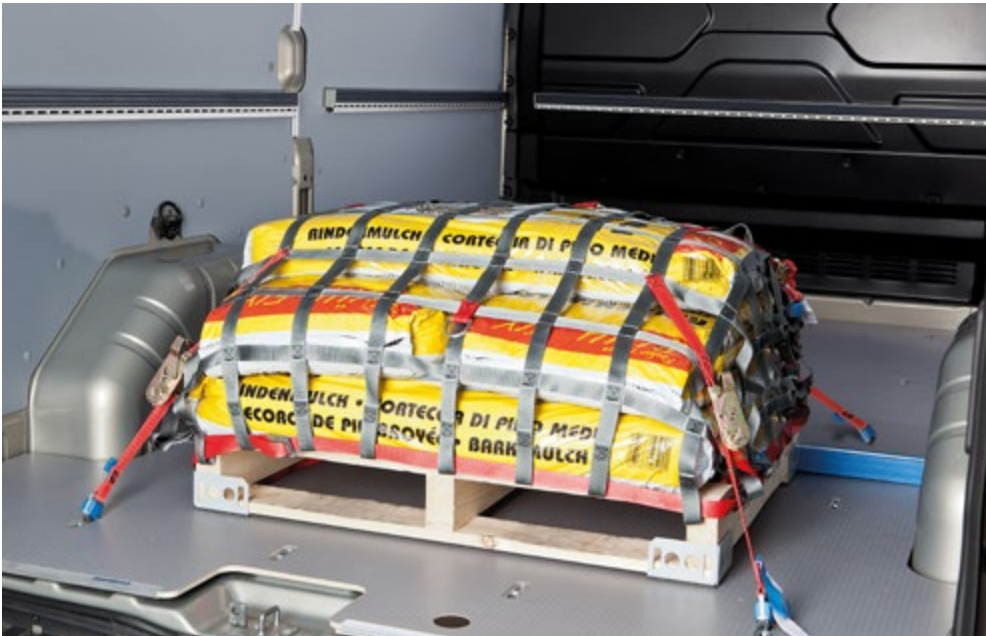
Abb. 3.5.6-02 Niederzurren eines freistehenden Ladungsguts
