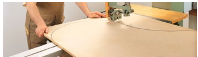
Abb. 3.1.6-09 Sägen sperriger Werkstücke mit zusätzlicher Tischverbreiterung
