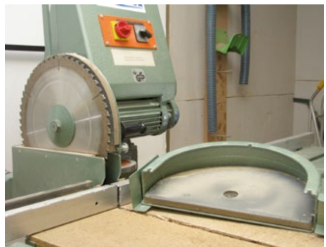
Abb. 3.1.5-07 Auskleidung an Schutzhaube zur Lärmreduzierung
