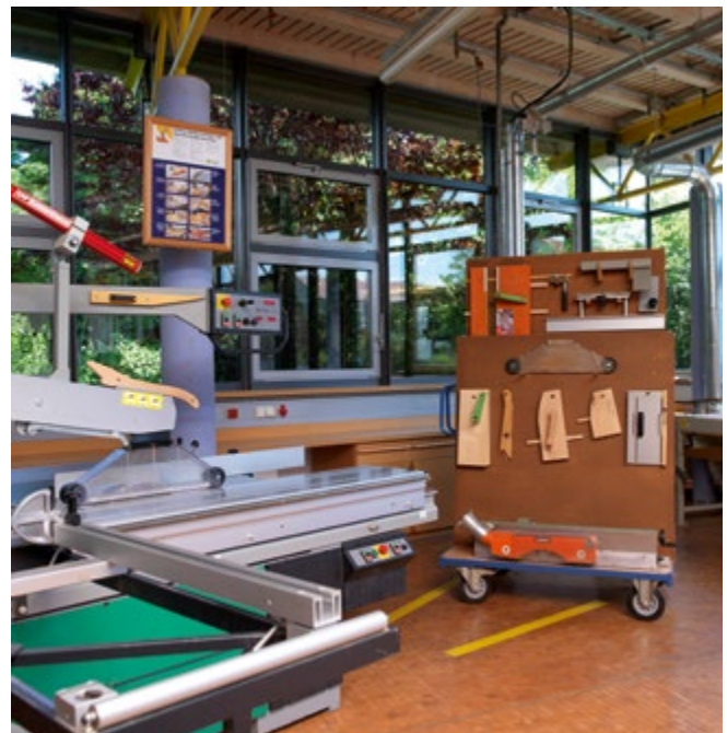
Abb. 2.2.2-04 Formatkreissäge mit zugehörigen Schutzvorrichtungen
