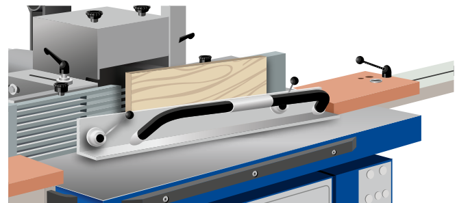
Abb. 3.1.7-06 Spannlade zum Einsetzfräsen kurzer Werkstücke
