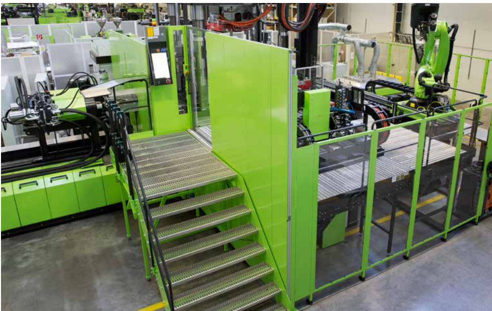
Abb. 13 Arbeitsbühne mit Treppe als Aufstieg an einer Spritzgießmaschine.
