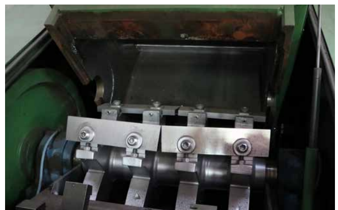
Abb. 75 Geöffnete Schneidkammer mit zugänglichen Messern auf der Rotorwelle im Inneren einer Mühle bei ausgeschalteter Maschine
