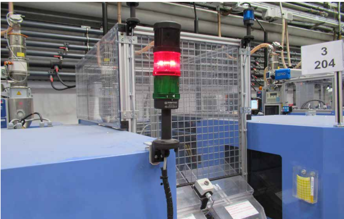
Abb. 49 Spritzgießmaschine mit Maschinenampel
