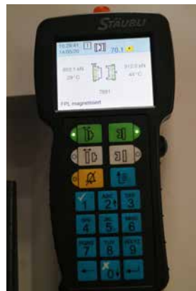
Abb. 55 Bedien- und Überwachungseinheit für ein Magnetspannsystem bei eingeschalteter Magnetisierung
