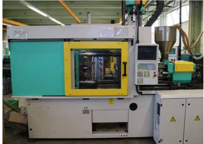
Abb. 66 Die Verdeckung an der Ausfallöffnung wurde nach dem Entfernen ordnungsgemäß wieder montiert, um den Eingriff in Gefahrstellen zu verhindern
