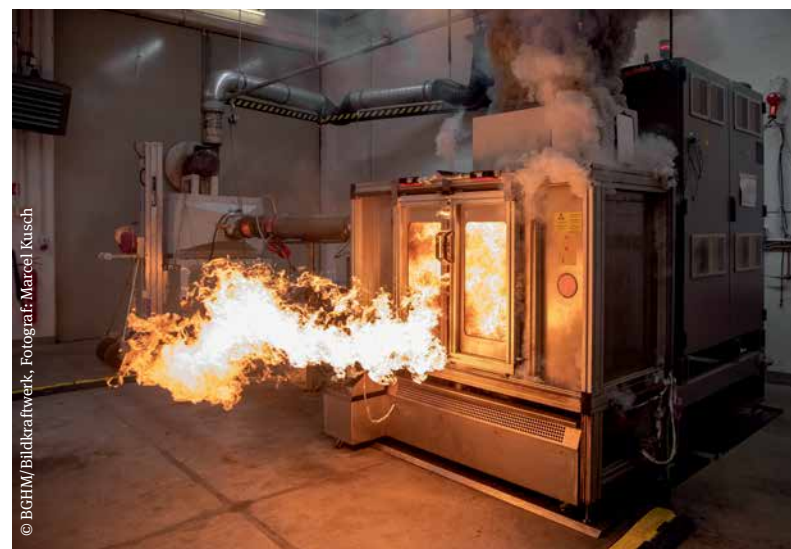
Ein Versuch im Forschungslabor zeigt, wie stark sich die Flammen in einer Werkzeugmaschine bei einer manipulierten Schutzeinrichtung ausbreiten können.
