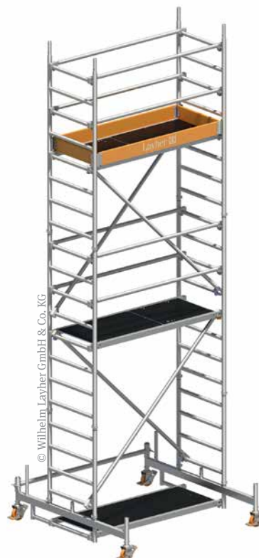
Bild 2: Um die Absturzgefahr zu verringern, darf der Abstand zwischen den Belagflächen nicht mehr als 2,25 Meter betragen.
