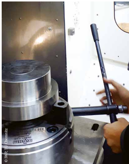
Ein Proband spannt ein Werkstück im Handspannfutter mithilfe eines konventionellen Futterschlüssels.
