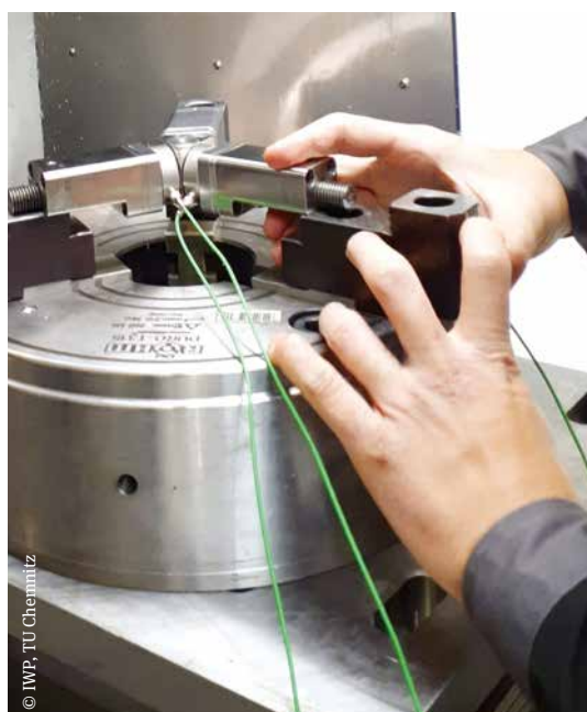
Ein Proband positioniert das Spannkraftmessgerät für die Spannkraftmessung.
